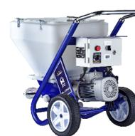
После включения переключателя источника воздуха медленно отрегулируйте переключатель потенциометра по часовой стрелке (как показано на рис. 5) и еще раз убедитесь, что труба материала и каждая соединительная часть целы и не имеют утечек, а затем залейте подготовленный для нанесения материал.
